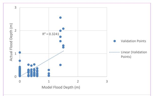
Figure 107. Flood map depth vs actual flood depth
