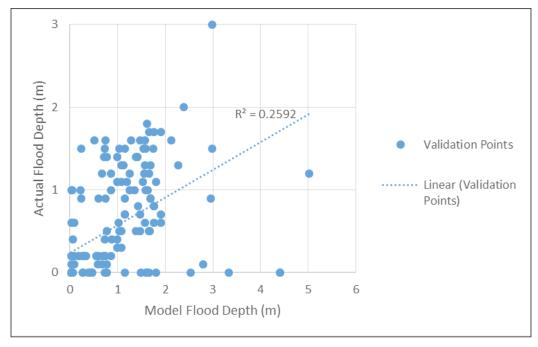
Figure 73. Flood map depth vs. actual flood depth
