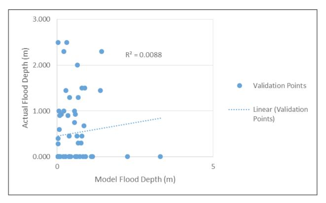
Figure 74. Flood map depth vs. actual flood depth
