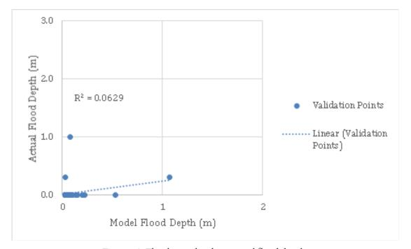
Figure 72 Flood map depth vs actual flood depth.
