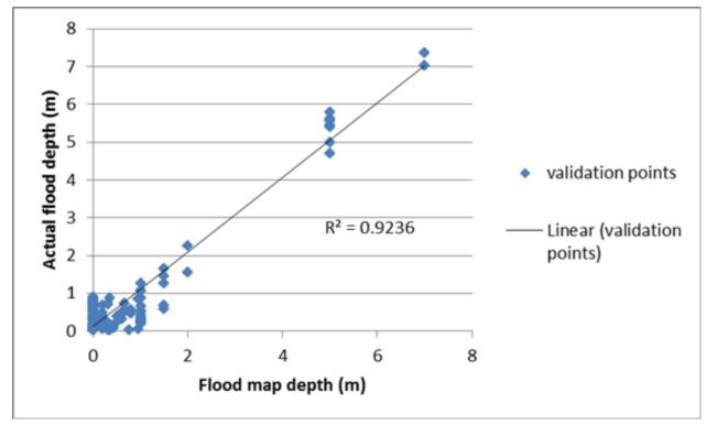
Figure 83. Flood map depth versus actual flood depth
