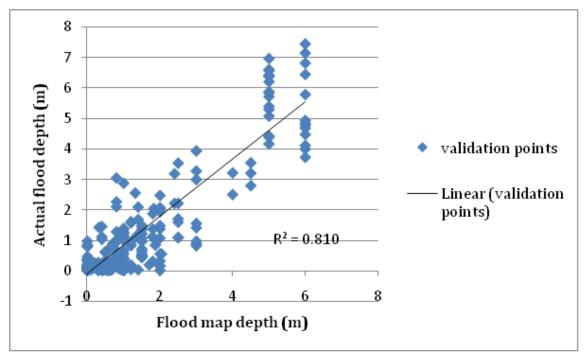
Figure 96. Flood map depth vs actual flood depth
