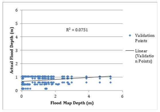
Figure 169. Flood depth map vs actual flood depth.
