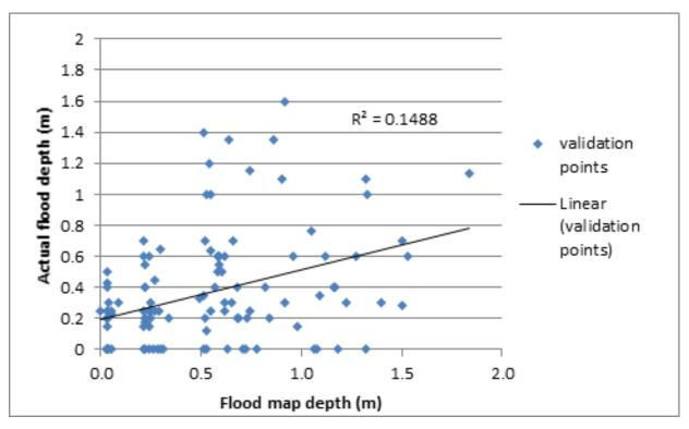
Figure 100. Flood map depth vs actual flood depth
