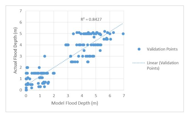
Figure 82. Flood map depth vs. actual flood depth
