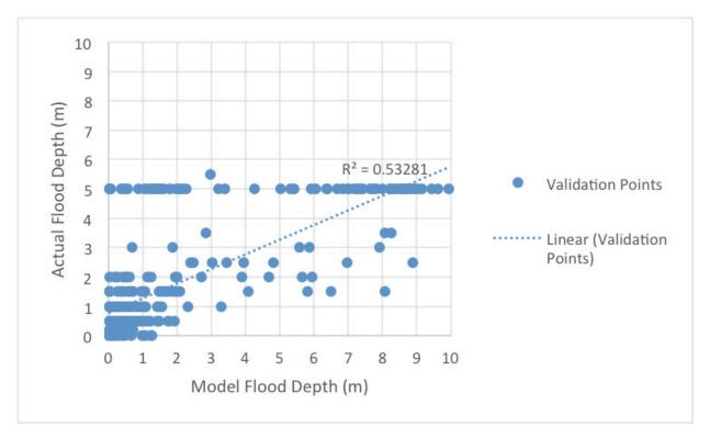
Figure 75. Flood map depth vs actual flood depth
