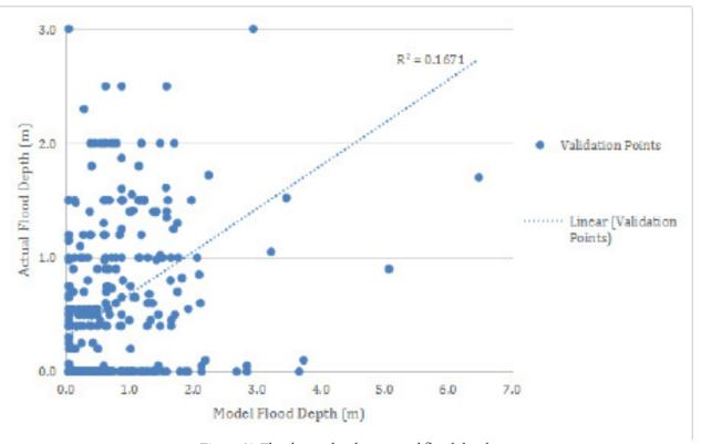
Figure 81. Flood map depth vs. actual flood depth
